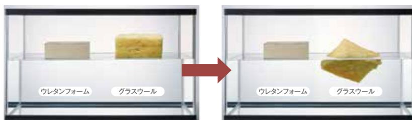
グラスウール(右)は水が染み込み約3分の2沈んでしまいました。硬質ウレタンフォーム(左)は水を通しにくい素材であることが確認できます。
